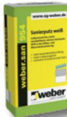
**weber.san 954** ist geeignet zur dauerhaften Sanierung durchfeuchteter und salzbelasteter Flächen. Der Sanierputz enthält organische Leichtzuschläge und ist dadurch besonders leicht zu verarbeiten. Der Putz weist eine sehr geringe kapillare Leitfähigkeit, sehr gute Wasserdampfdurchlässigkeit und ein hohes Porenvolumen auf. Er kann mit einem zum System gehörenden Oberputz, z.B. **weber.san 956 Feinputz** überarbeitet werden. Alternativ ist ein Anstrich mit **weber.san Silikatfarbe** möglich.
